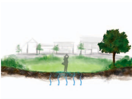
Rysunek 5. Zbiornik chłonny wykorzystywany w czasie pogody suchej jako teren rekreacyjny (schemat) i odbierający wodę z terenu ulic i parkingów
